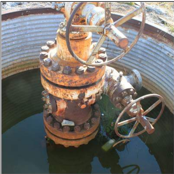
Fig. 24 A,B. Pozzi abbandonati con chiusure metalliche che si stanno arrugginando.
