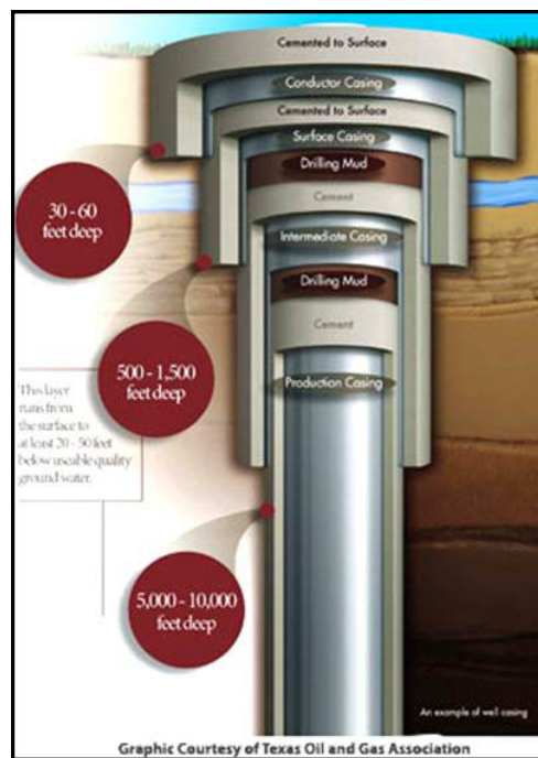
Fig. 27 - A,B. A sinistra: struttura di un pozzo di esplorazione e di produzione; a destra: colonna di rivestimento telescopica del pozzo petrolifero con segmenti di tubi metallici cementati tra loro.
