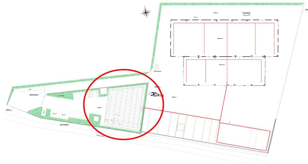
**Figura 1: Stralcio planimetrico con indicazione delle tubazioni di aspirazione (linee rosse) e biofiltro**
